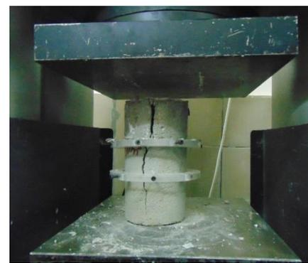
(d) Failed Specimen under Compression
